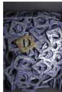
Die Teile werden von der Bildverarbeitungssoftware markiert und bewertet.
