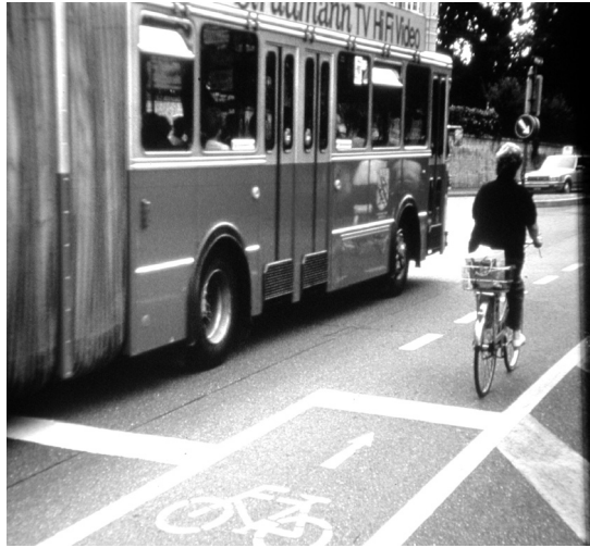
Abbildung 9: An lichtsignalgesteuerten Knotenpunkten bringen vorgezogene Haltebalken für den Veloverkehr nicht nur einen Sicherheitsgewinn, sondern leisten auch einen wichtigen Beitrag an die Erhaltung der Leistungsfähigkeit des Knotenpunktes.
