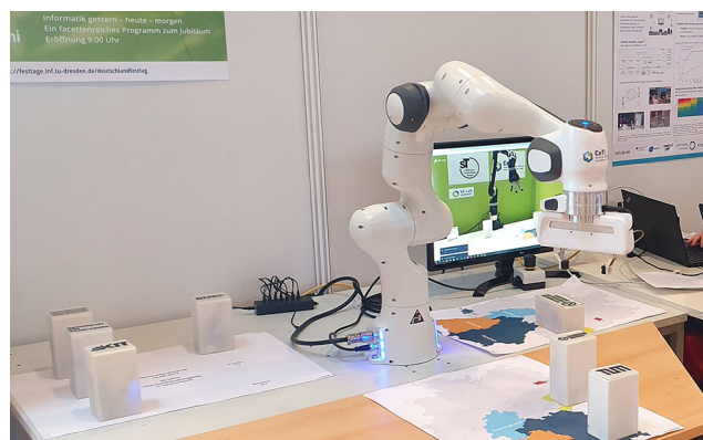
Abb. 4 Aufbau des Ausgabeplatzes der Co-Roboterzelle
