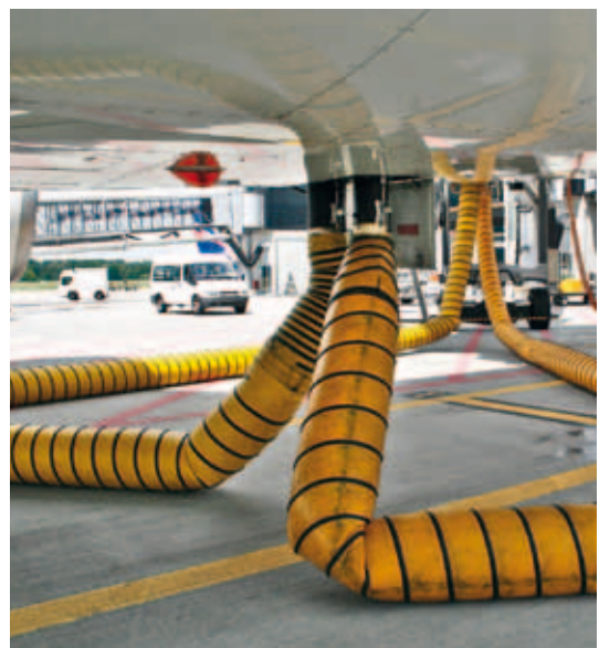
Die gelben Schläuche leiten klimatisierte Luft in die Kabine des Flugzeugs, angeschlossen an einem Langstrecken-Jet der Swiss.
