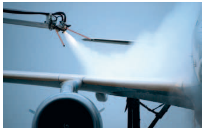
Im Winter sind Flugzeuge erst nach dem Enteisen startbereit: Tragflächen werden dabei mit einem Glykolkemisch enteis.
