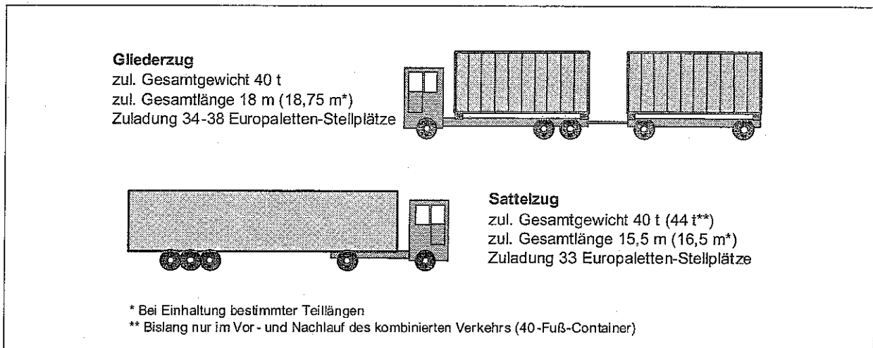
Abb. 3: Abmessungen und Vorschriften für Glieder- und Sattelzüge (Quelle: Mit Änderungen entnommen aus Buchholz/Clausen/Vastag (1998), S. 106)
