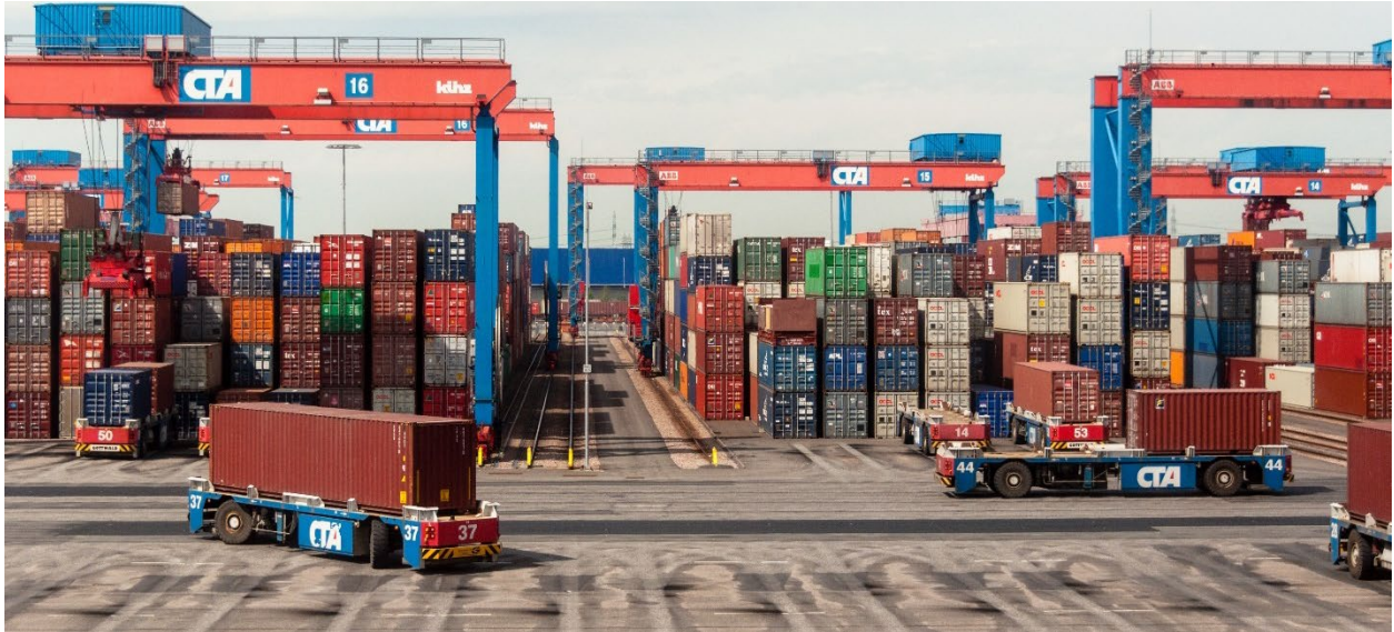
Abbildung 17: Container Terminal Altenwerder im Hamburger Hafen - HHLA Hamburg: Elektrisch angetriebene AGVs stellen Container auf die Sekunde genau bereit
